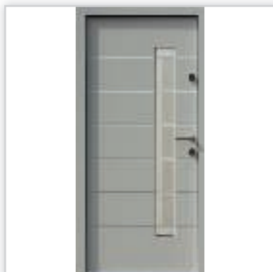
AFB. Drzwi wejściowe zewnętrzne model 476,1 systemu E-82. Wymiary zewnętrzne ościeżnicy [cm]: 98/209. Grubość [mm]: 82. Wyposażenie: zamek listwowy klasy „C” na dwie wkładki, 4 kołki antywłamaniowe. Szklenie: pakiet 3 szybowy z szybą niskoemisyjną P1. Materiał: klejone warstwowo drewno mahoń-meranti. Ocieplenie [mm]: 58. Współczynnik przenikania ciepła U_d [W/(m 2 K)]: 0,7. Gwarancja: 4 lata. Cena netto [zł]: 4066.
